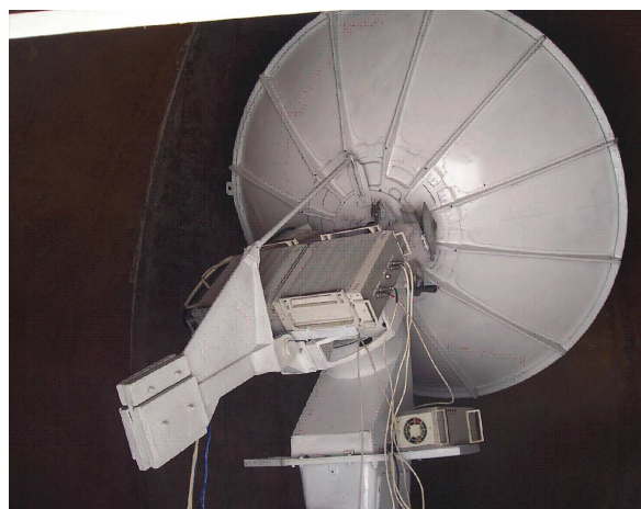
Рис. 2. Радиотелескоп на частоты 6 и 10 ГГц
