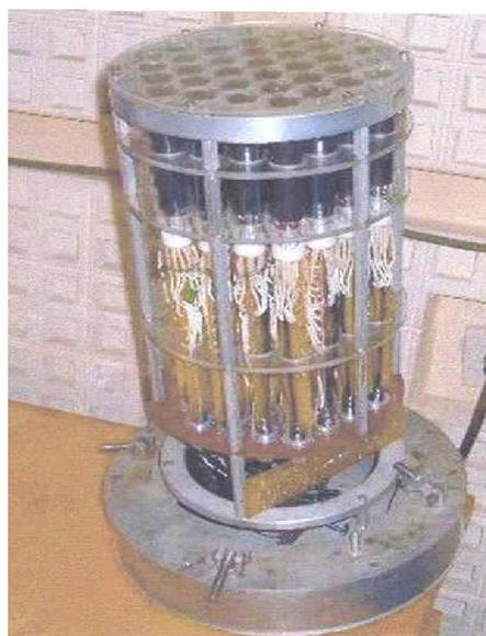
**Рис.3.** Общий вид одной из 37- канальных камер телескопа
