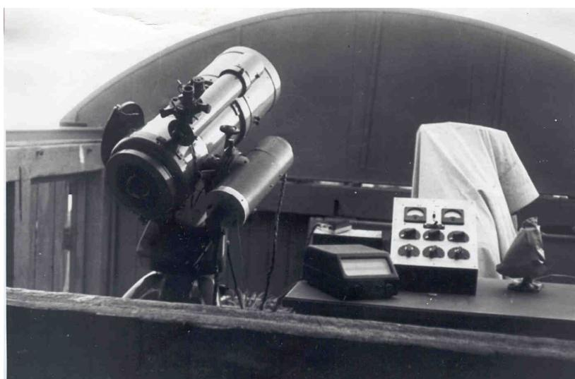
**Рис. 1.** Первый в КрАО электрофотометр, установленный на телескопе МТМ-200. На столе расположен прибор для измерения тока (гальванометр) и усилитель с ручками управления.
