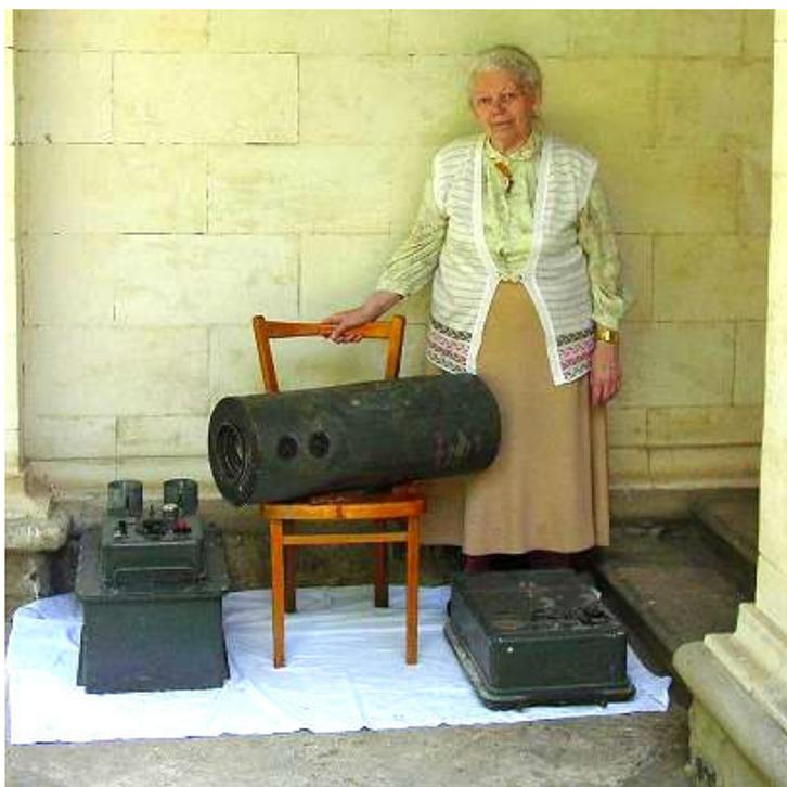
**Рис. 4.** Фотографии аппаратуры, использованной при испытаниях 6-камерного ЭОП. Слева – высоковольтный блок питания каскадов ЭОП, в центре – соленоид, в котором помещался ЭОП, справа – блок питания катушек соленоида для фокусировки электронов каждого каскада. На снимке участница испытаний В.В. Прокофьева-Михайловская.
