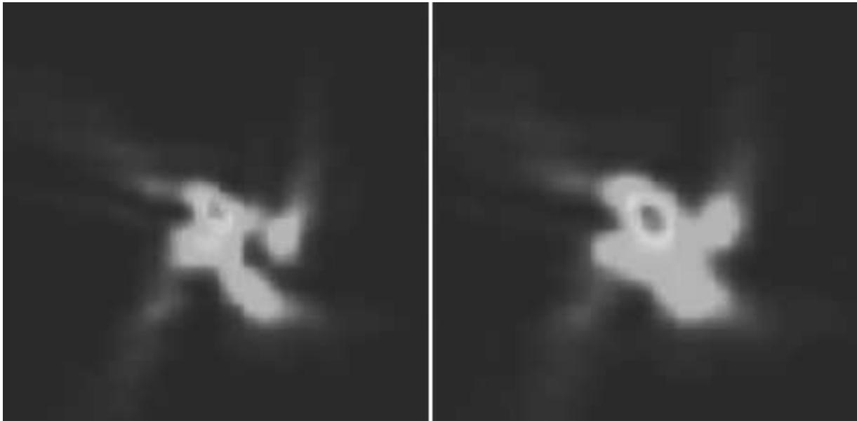
**Рис. 1.** Результаты теоретического расчета дифракционной картины от монохроматического точечного источника в фокальной плоскости астрометрических телескопов GAIA. Слева – длина волны 600 нм, справа – 900 нм.
