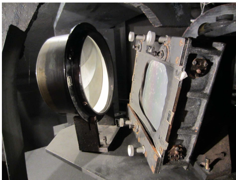
Рис. 11. Решетка-эшелле и призма с вертикальным направлением дисперсии
