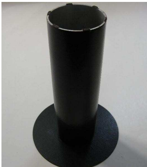
Рис. 17. Стержень – приспособление для монтажа/демонтажа дифракционной решетки
