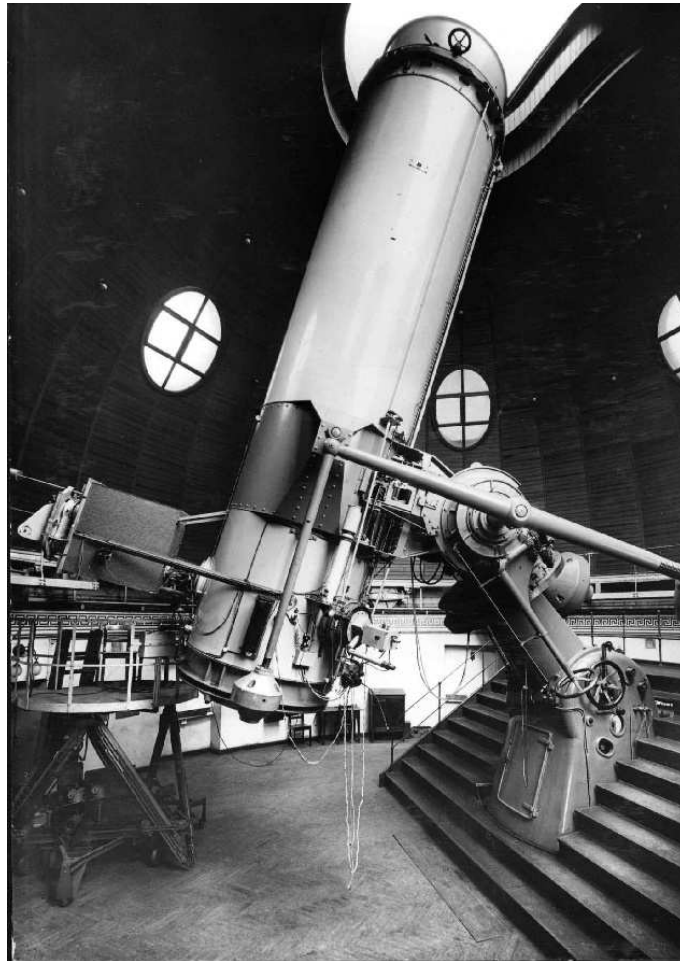
Рис. 2. 122-см телескоп в Бабельсбергской обсерватории. В фокусе Кассегрена установлен трехпризменный спектрограф в термостабилизирующем корпусе (слева) и фотометр Гутника (справа)
