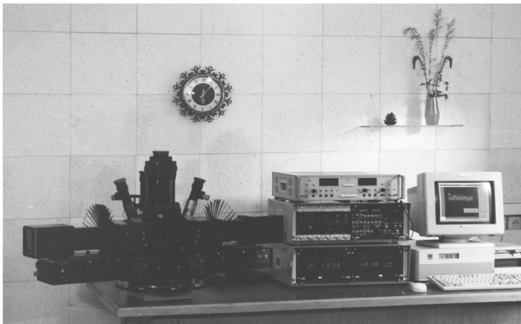
Рис. 2. Двухканальный скоростной фотометр ОСТАП-Б в лаборатории
