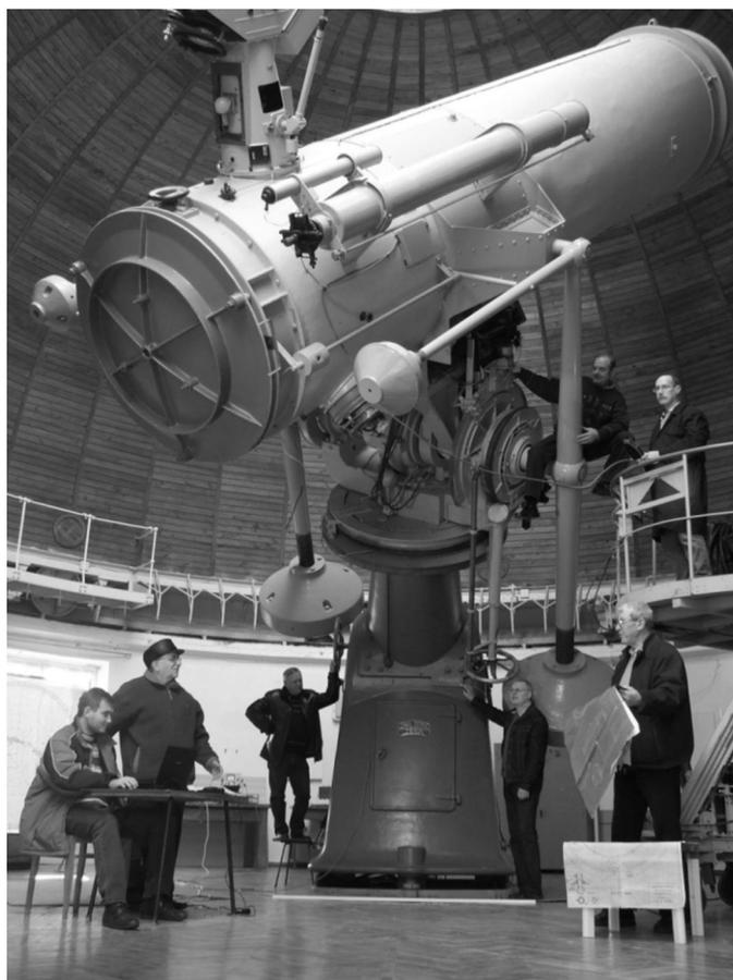
**Рис. 3.** Реконструкция телескопа Zeiss-50"
