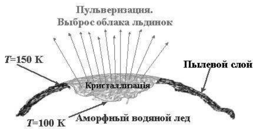
Рис. 1. Пульверизация поверхностного слоя кометного ядра из-за кристаллизации аморфного льда
