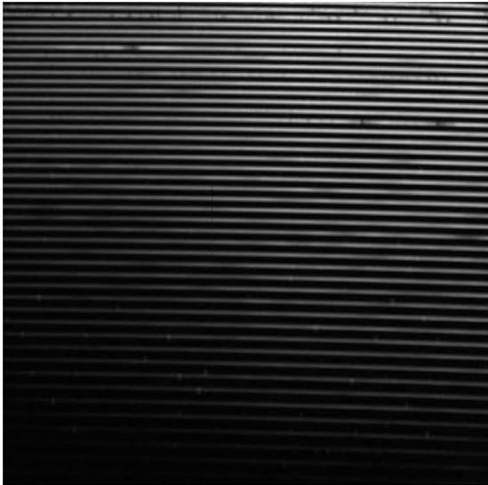
**Рис. 3.** Изображения спектра звезды SU Aur (G2 IVe) на экране монитора при использовании призмы в качестве кросс-дисперсора. Красная область вверху. Широкая эмиссионная линия  $H_{\alpha}$  с центральной абсорбцией заметна слева вверху, а ниже справа виден дублет натрия
