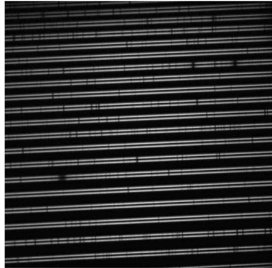
**Рис. 4.** Изображение спектра  $\beta$  Aql (G8 IV) на экране монитора при использовании дифракционной решетки в качестве кросс-дисперсора. Красная область внизу. Спектр получен с анализатором циркулярно-поляризованного света, поэтому каждый порядок разделен на два спектра. Сильная линия в нижней части изображения –  $H_{\alpha}$ . Хорошо заметен в правом верхнем углу дублет натрия
