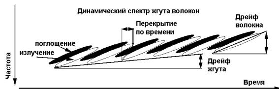
Рис. 5. Эскиз, поясняющий обозначения параметров жгута волокон
