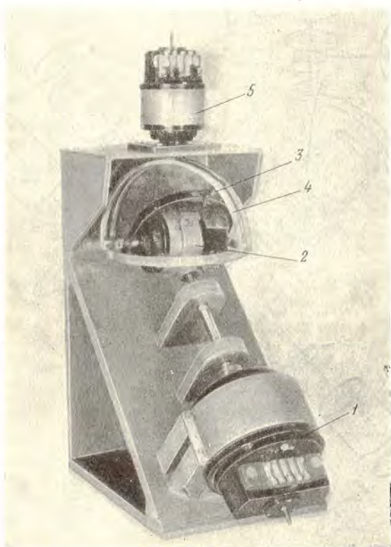
Фиг. 7. Преобразователь координат типа ПК-I: 1 — СП_t — сельсин-приемник по t , 2 — СП_\delta — сельсин-приемник по \delta , 3 — поводок, 4 — дуга ПК (мает щели купола), 5 — СД_A — сельсин-датчик по A .
