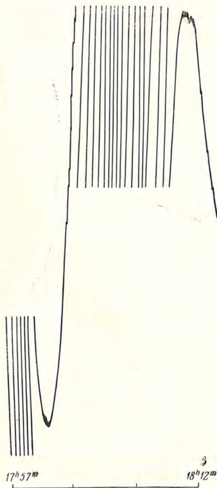
Фиг. 2. Быстрое возрастание магнитного поля ( z -компонента), зарегистрированное во время магнитной бури 4 сентября 1957 г. в 18 час. 02 мин. На записи заметны следы КПК, отчетливо зарегистрированные вторым флюксметром (см. фиг. 3). Время мировое
