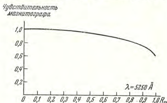
Фиг. 4. Изменение чувствительности магнитографа в зависимости от удаления от центра диска Солнца участка его поверхности, где записывается магнитное поле.
