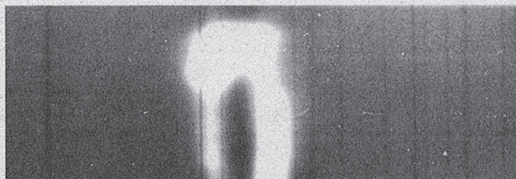
Рис. 3. Спектрограмма одной из послевспышечных петель над краем Солнца в области линии H\alpha , щель ориентирована вдоль петли, высота щели около 60 угл. сек; 11^h55^m UT.
