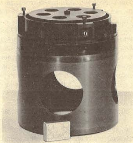
Рис. 5. Узел коллиматорного зеркала
