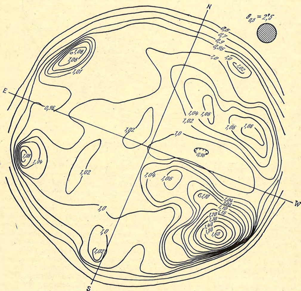
Рис. 2. Распределение радиояркости по диску Солнца на волне 13,5 мм 06.04 1979 г Числа у изофот указаны в единицах антенной температуры невозмущенного Солнца (09.10 УТ, V_0 = 6^\circ )
