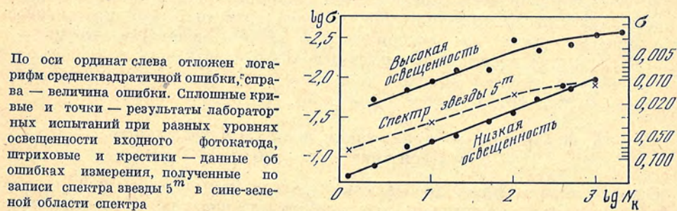
Рис. 4. Зависимости средней квадратичной ошибки измерения интенсивности в одном канале от числа кадров N_k , суммированных в вычислительном устройстве
