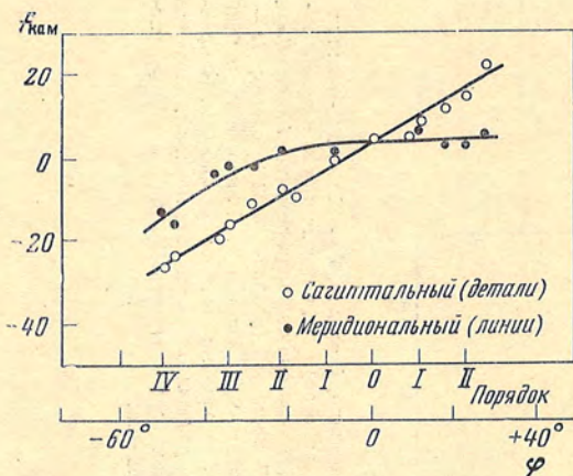
Фиг. 2. Изменение сагиттального и меридионального фокуса решетки с углом поворота решетки \varphi
